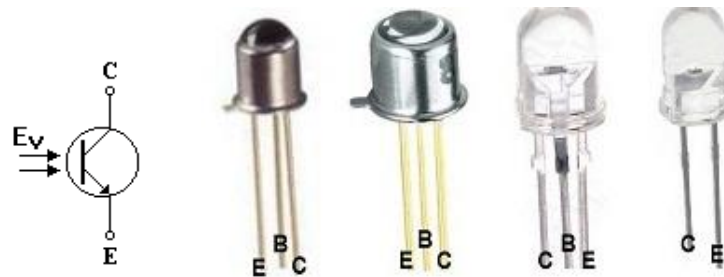
Fig. 4.53. Simbolul fototranzistorului și exemple [26]
