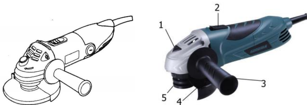
Fig. 1.12. Polizor unghiular (1- buton de blocare; 2- comutator pornit/oprit; 3- mâner auxiliar; 4- apărătoare disc de tăiere; 5- flanșă exterioară) [4]
