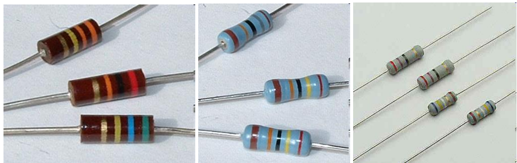
Fig. 4.3. Tipuri de capsule de rezistoare: a - cu peliculă de carbon; b – cu peliculă metalică; c – bobinate [18]
