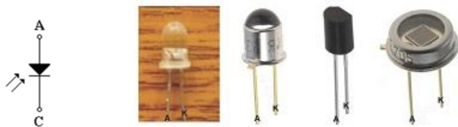
Fig. 4.52. Simbolul fotodiodei și exemple [27]
