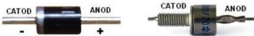
Fig. 4.31. Diode redresoare: a – în capsulă de plastic; b – în capsulă metalică [22]
