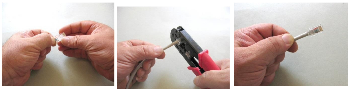
Fig. 6.42. Etapele sertizării unui conector RJ-45 [37]
